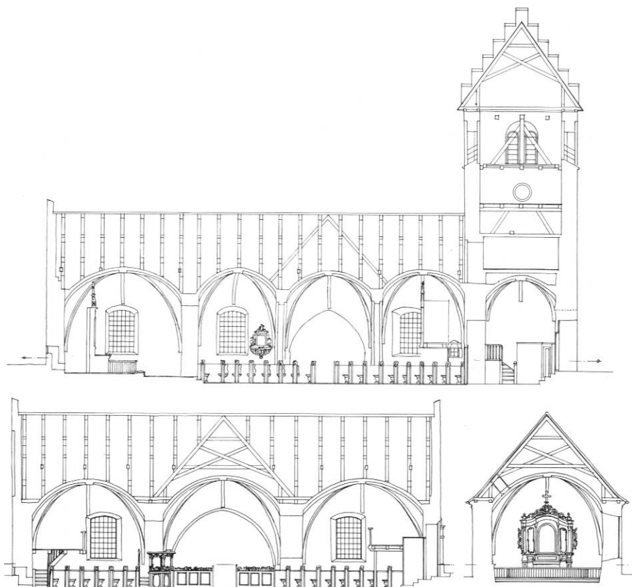
Fig. 19-21. Opmålinger forud for ombygningen 1933-35. 1:300. 19. Længdesnit set mod syd. 20. Tværsnit gennem skib og korsarme set mod øst. 21. Tværsnit af kor set mod øst. Målt og tegnet af Hother Paludan 1930. - Abmessungen vor dem Umbau. 19. Längsschnitt gegen Süden. 20. Querschnitt durch Schiff und Kreuzflügel gegen Osten. 21. Querschnitt durch Chor gegen Osten. Vermessen und gezeichnet 1930.
